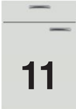
Grifflage 11 Waagrecht/Waagrecht Griffe werden generell waagrecht angeordnet.
