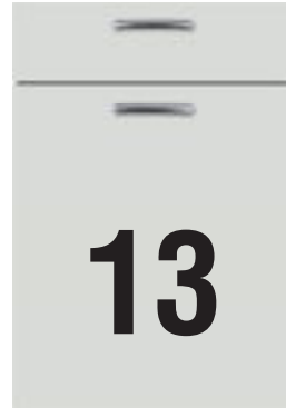
Grifflage 13 Waagrecht zentriert Griffe werden generell waagrecht zentriert angeordnet.
